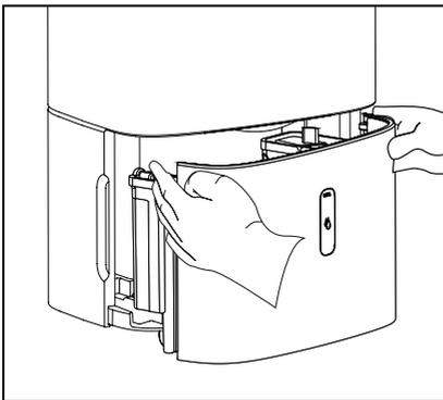
3. 握住水箱把手，並打開側邊角落的水箱密封蓋，然後清空水箱內的水份。
